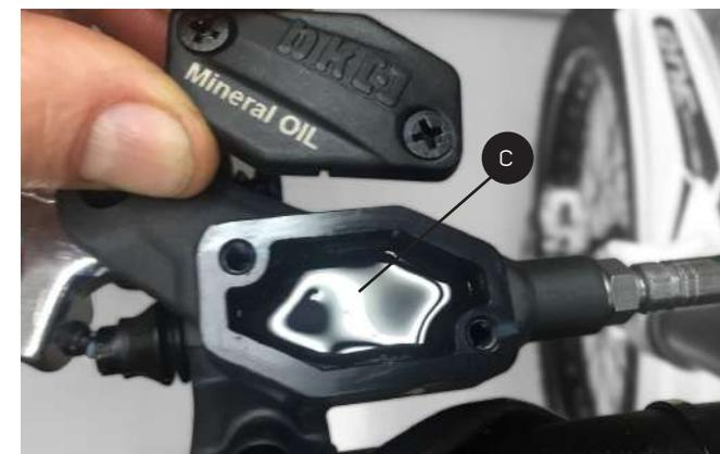
c) Serbatoio pompa frizione. Utilizzare esclusivamente olii minerali per evitare di danneggiare le tenute.
