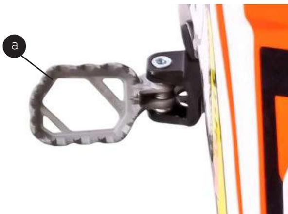
a) Le pedane sono regolabili e possono essere avanzate o arretrate da 2,5 a 5 mm sostituendo semplicemente la posizione delle rondelle assemblate sulle parti
