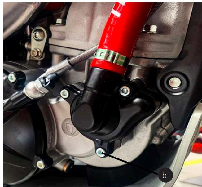
b) Vite per lo scarico del liquido refrigerante, situata nella parte inferiore della pompa acqua
