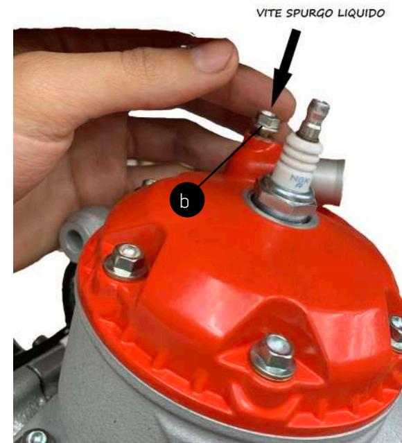
*b) Vite di spurgo del liquido refrigerante, situata nella parte superiore del coperchio testa*
