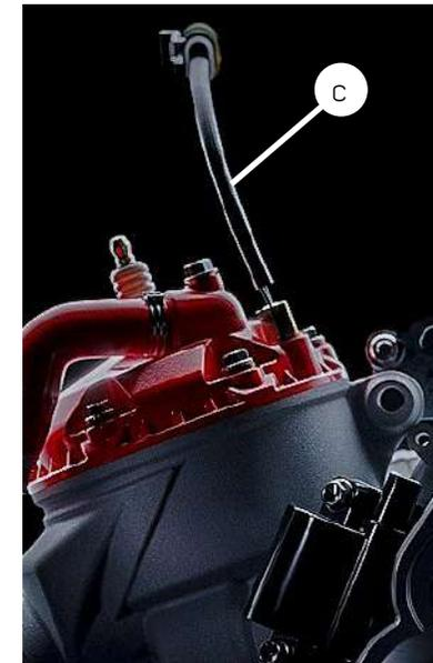
c) Sensore della temperatura inserito direttamente nel coperchio testa
