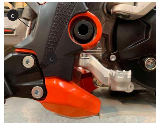
c) Astina di regolazione del pedale freno posteriore
