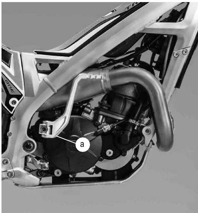
a) Leva accensione, nel lato destro della TRS
