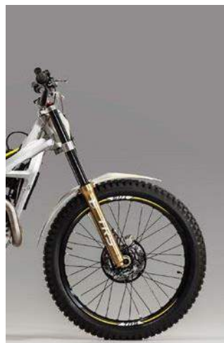
a) Nel lato destro della sospensione si può regolare l'estensione.
