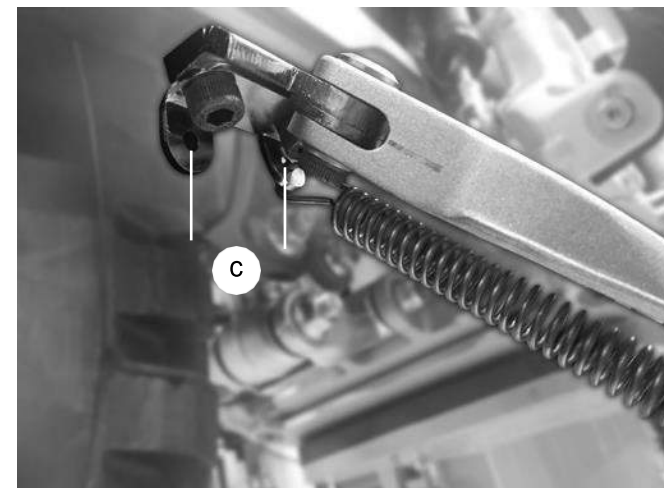
c) Fori di regolazione del cavalletto
