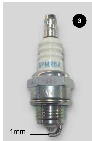
a) La candela che viene installata è quella descritta nella pagina delle caratteristiche. Deve essere stretta a 11Nm.
