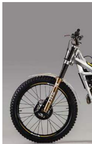
b) Nel lato sinistro della sospensione si può regolare il precarico della molla.
